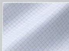
導電性繊維をグリッド状に織り込んだ表面抵抗値の低い高制電素材を採用。(FL153C・FL154C)
